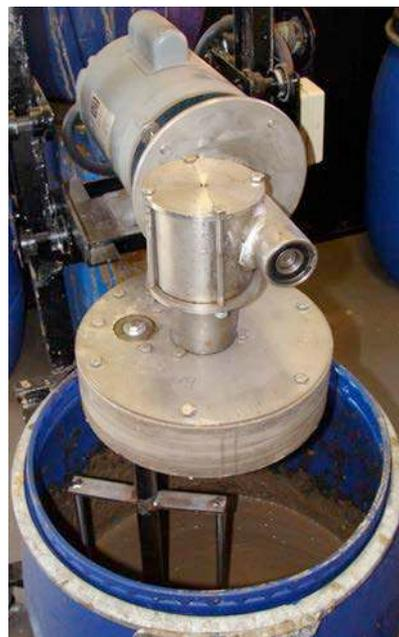
Mezcladora orbital con aspas de acero inoxidable después de incorporar al pescado molido el ácido.
