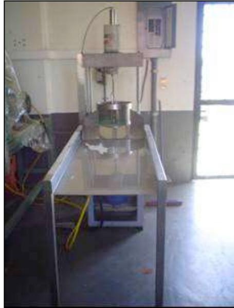
Molino diseñado para triturar el pez armado entero o en partes.
