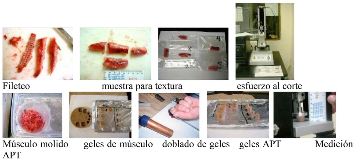
Fotografías músculo para esfuerzo al corte para medición de textura y de los geles para APT del almacenamiento en hielo.
